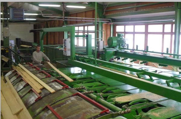
Vstupní část – separace, vykracování, měření
